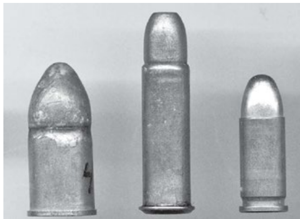
French WWI handgun cartridges (L to R): 11mm Car-touche d’Ordnance Modèle 1873/90, 8mm Cartouche d’Ordnance Modèle 1892 and Cartouche de 7,65mm pour P.A. (Lou Behling photo)
